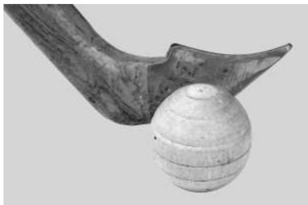
La choulette française a une hauteur de 4,5 centimètres, et une largeur de 3,5 centimètres. La hauteur utile du plat de la tête est de 3,5 centimètres, sa largeur utile de 3,5 centimètres. Le pic a une largeur de 3,5 centimètres et une hauteur de 5,5 centimètres.
